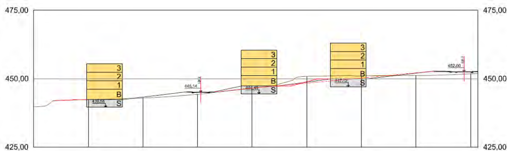
Figura 10. Exemple d'adequació de l'ordenació a la topografia
