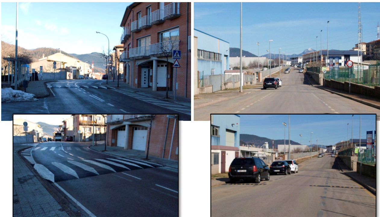
Figura 5-3. Elements reductors de velocitat als voltants del sector (Av. del Morrot i C/ de França)
